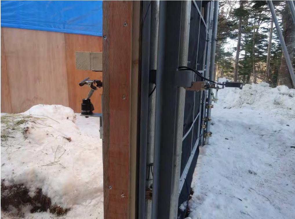
写真 6. 自動捕獲装置のセンサー部分 (左手ワナ内、右手ワナ外).
