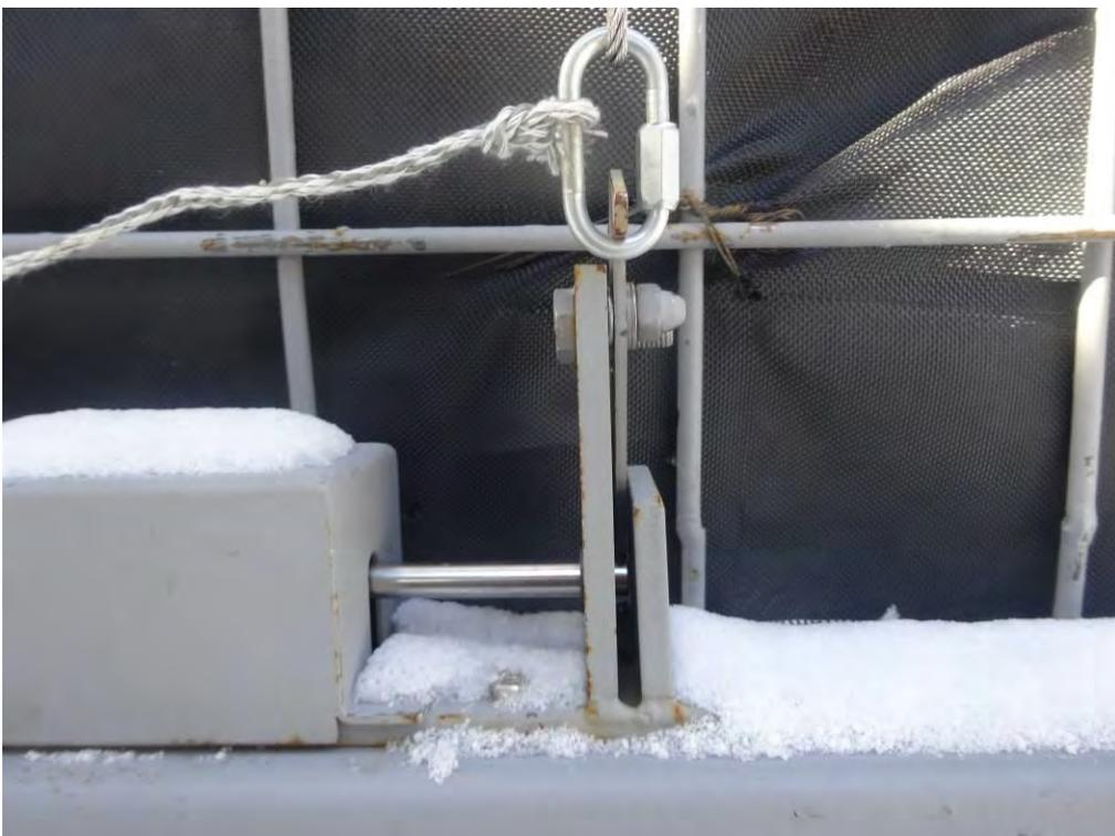
写真 7. 自動捕獲装置のトリガー部分.
