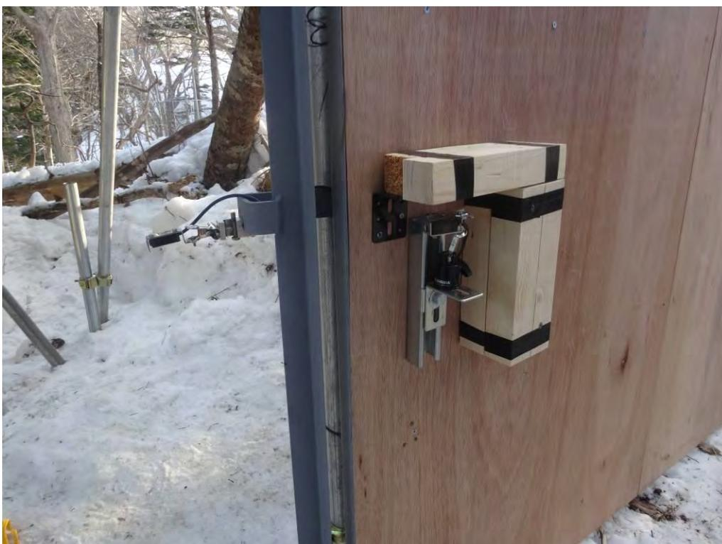
写真 5. 自動捕獲装置のセンサー部分（手前がワナ内部）.
