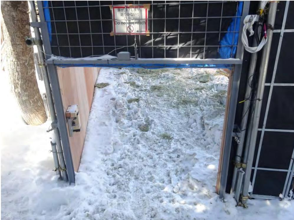
写真 8. エゾシカ捕獲用の鋼製落とし扉の外観（扉開放時）.
