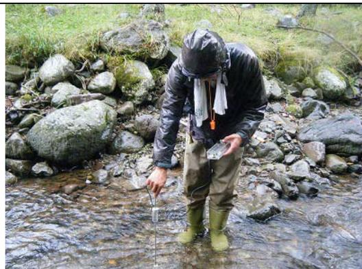
テッパンベツ川 流速計測状況
