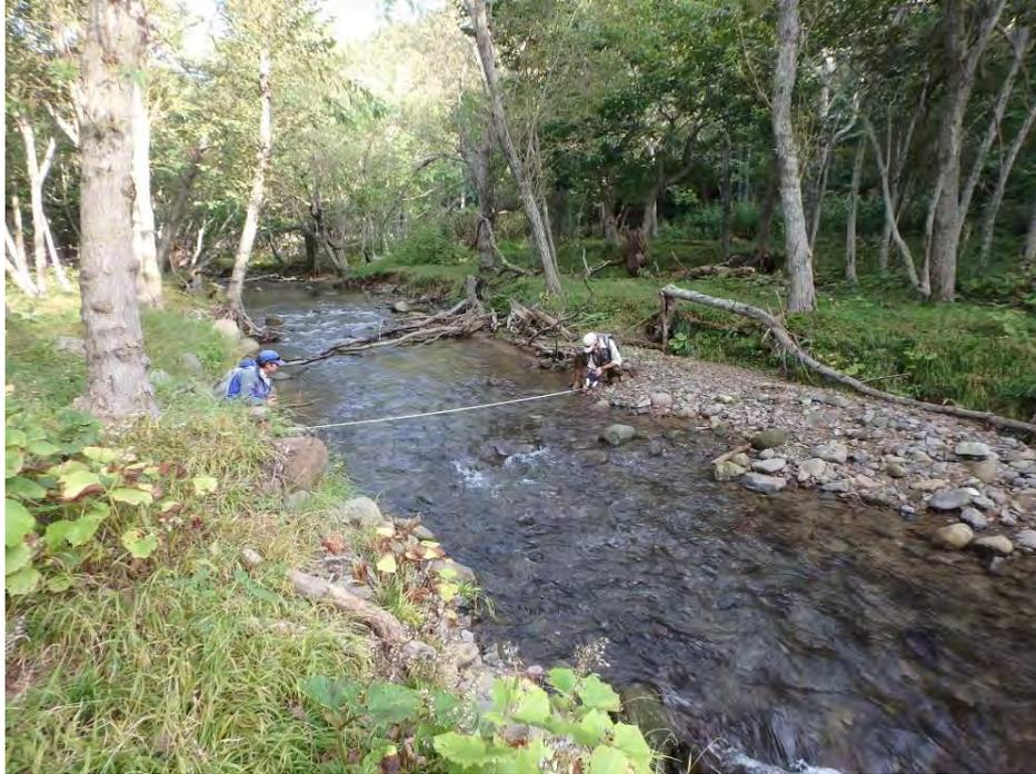
写真3. テープメジャーを使用して河床幅を計測する様子
