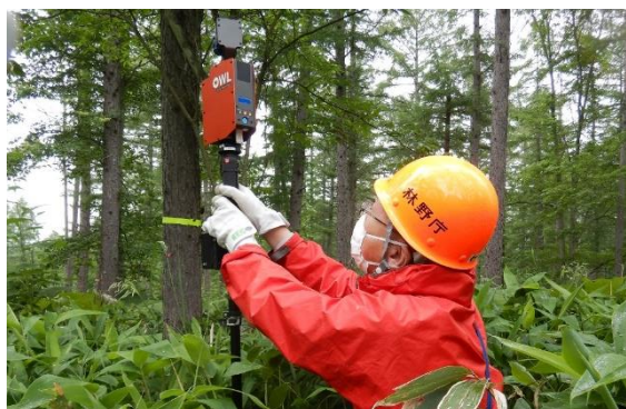
地上型3Dレーザスキャナ（OWL）設置状況
