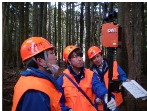
地上型3Dレーザスキャナ（OWL）実測状況
