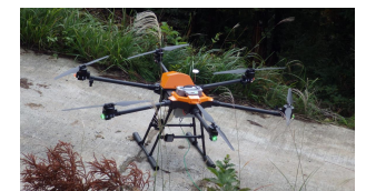
大型ドローンを用いたリードロープのけん引 (実証)
