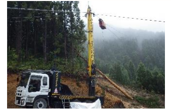
ホイール式タワーヤーダ- (コンラート社 オーストリア製)
