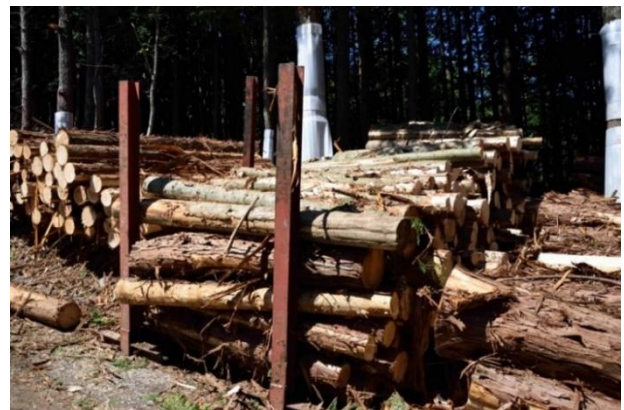
(原木の仕分けのための鉄骨製支柱)
