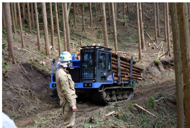
(フォワーダによる運材作業)
