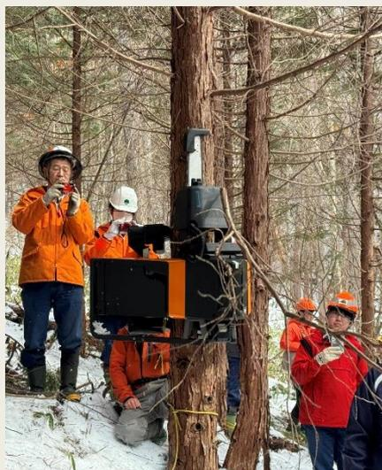
樹木を挟むように枝打ち機をセットし、リモコンに条件を打ち込み稼働スタート。回転しながら上昇し、枝を自動判定してチェーンソーで切断を行う。
