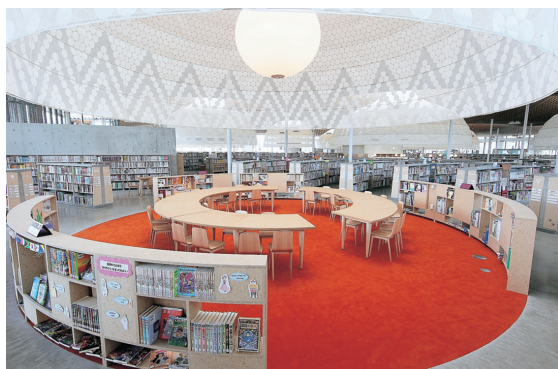
岐阜県産ヒノキのストランドボードを 書架、収納ケース、テーブルなどに使用 (ぎふメディアコスモス)
