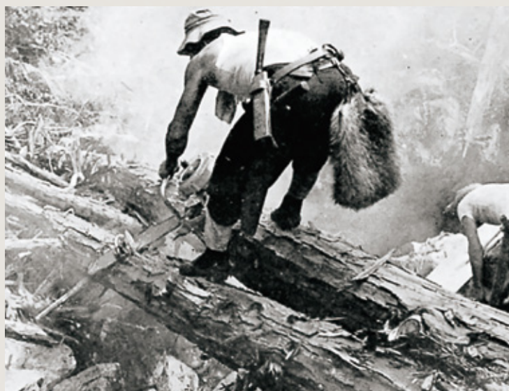
昭和30年頃 チェーンソーによる枝払い作業 (現在の木曾森林管理署管内)
