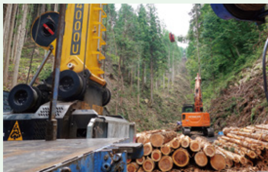
森林組合として全国で初導入したオーストリア製のタワーヤーダ(キャタピラ式)は、悪路や狭所の多い作業道をリモコン操作で自走でき、現場で活躍しています！
