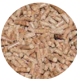
ペレット (乾燥した木材を細粉し、圧縮して円筒状に固めた木質バイオマス燃料)
