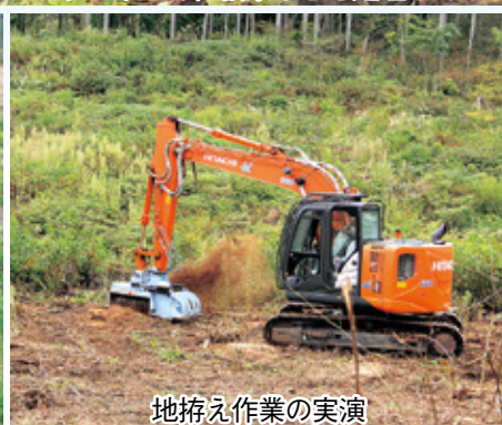
地拵クラッシャーで、枝条などを処理している様子
