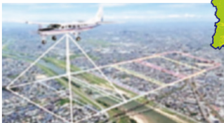
航空レーザ計測のイメージ：公共測量の手引（国土地理院）より
