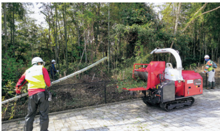
チップパーを使用し、竹を粉碎している様子
