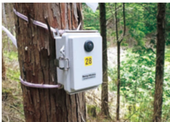
捕獲通報システムのセンサー (愛知所)
