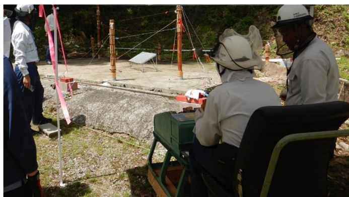
ミニ電動集材機を操作する研修生（岐阜森林管理署管内）
