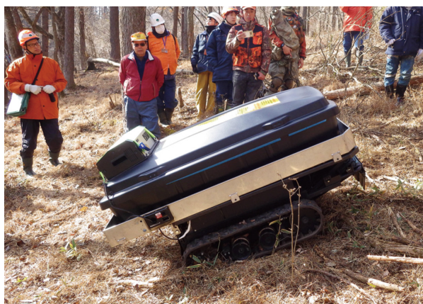
現地でのEV自走式冷却搬送機のデモンストレーション
