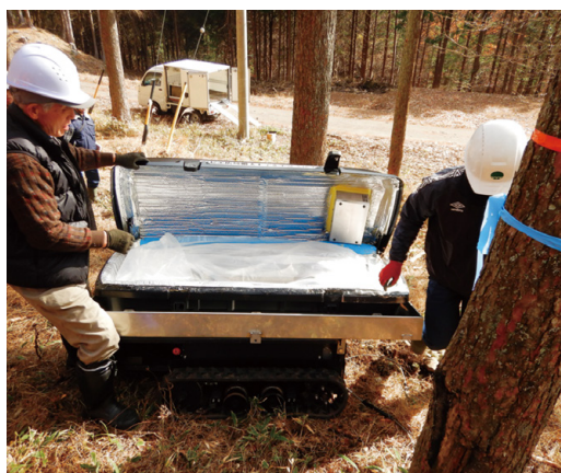
EV自走式冷却搬送機保冷装置の内部
