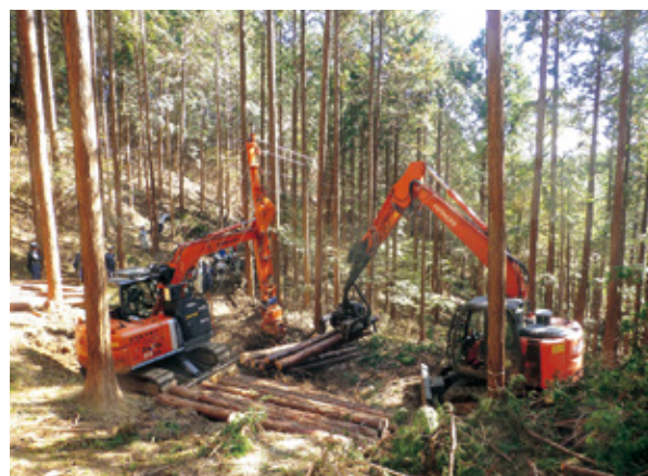
スイングヤダー(左) による集材の様子
