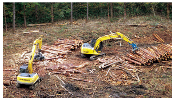
2台のグラップルの連携で 効率よく集造材する現場
