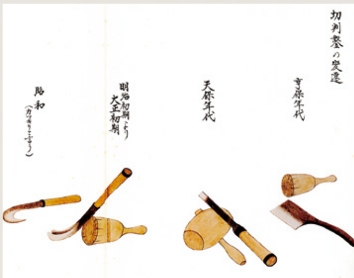
切判を握るノミの時代による変遷(「付知川に於ける材木伐出の沿革と絵解」より)
