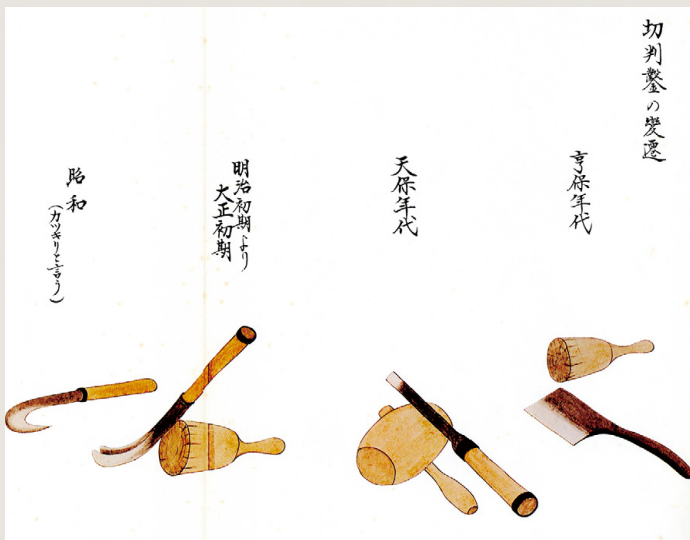
切判を掘るノミの時代による変遷 (「付知川に於ける材木伐出の沿革と絵解」より)
