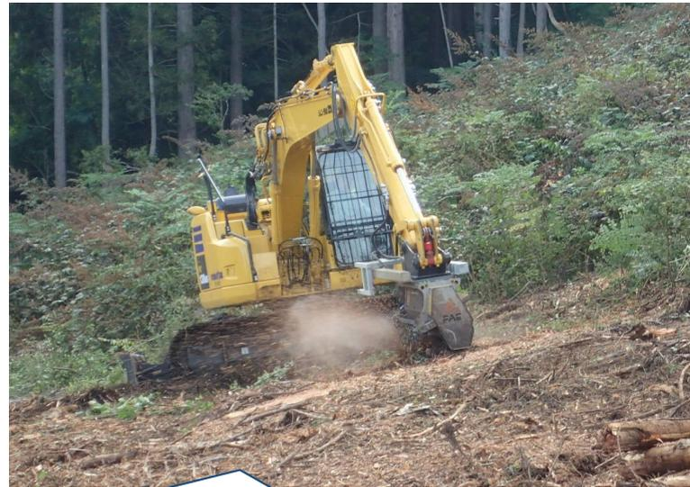
クラッシャーが根株を削る様子。タングステンのチップが削るように根株の高さを下げていき、さらに削る場所をずらしながら粉碎していくので、根株の大きさに関わらず作業が可能。
