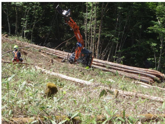
主伐（皆伐）箇所における集材作業
