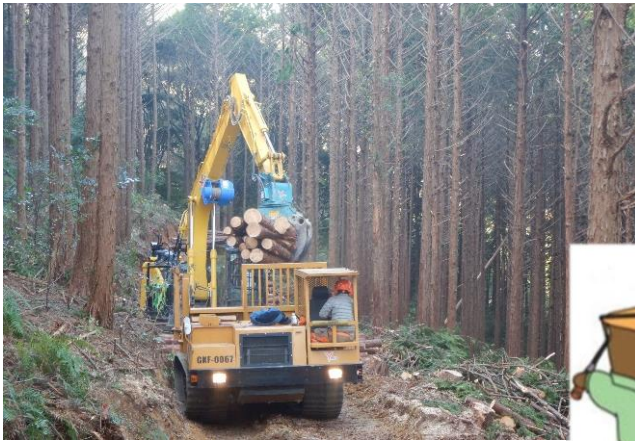
フォワーダによる間伐木の運搬作業（豊橋国有林）
