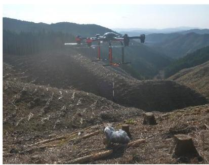
ドローンによるシカ柵資材の運搬
